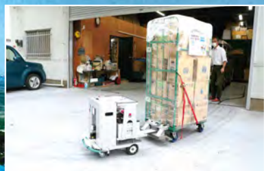
02. ロボット台車の走行テスト
